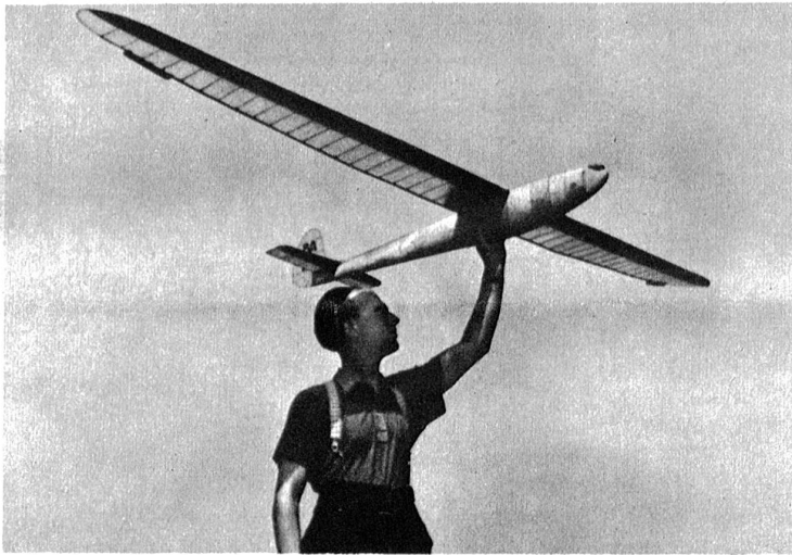
Elegantes Grossmodell: Flügel ungebogen gerade. Flügelnase aus dünnstem Sperrholz, ebenso ist der auskonstruierte Rumpf mit Sperrholz beplankt. Auf der Rumpfnase befindet sich ein Trimmgewicht zur Veränderung der Gleichgewichtslage. Die kleinen Klappen an den Flügeln aus Aluminium dienen zur Verbesserung der Stabilität.
