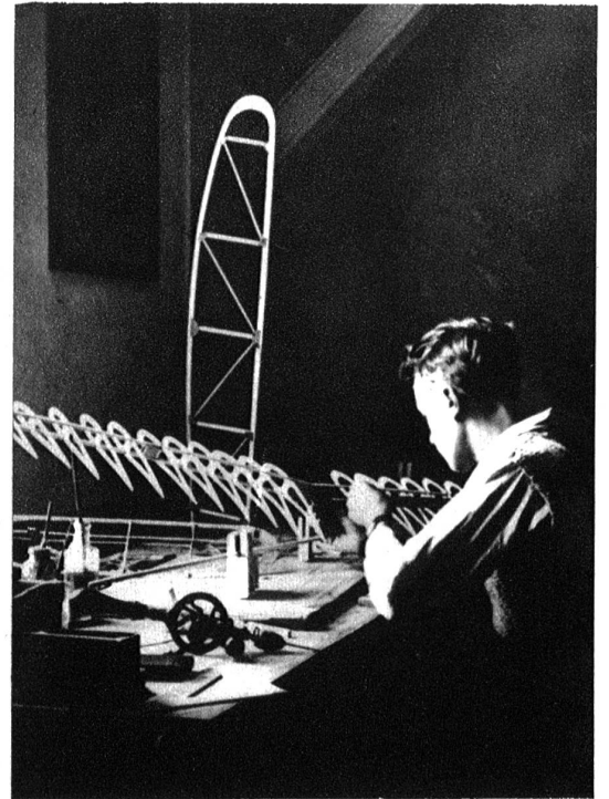
Flügel im Rohbau: Der junge Modellbauer setzt die Flügelrippen auf den Hauptholm. Diese Arbeit verlangt sehr viel Feingefühl, Ausdauer und Sorgfältigkeit. Im Hintergrund das Gerippe des Rumpfes. Das Dreieck als Bauelement.
