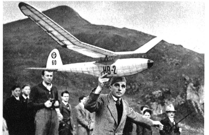
Erste Phase des Handstartes: Dieses Modell erreichte über 1000 m Startüberhöhung und legte eine Strecke von 7250 m zurück.
