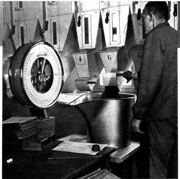
Der geröstete Kaffee verlässt die grossen, luftdicht verschlossenen Silos, wird auf einer fahrbaren Waage gewogen und dann für die Spedition bereingemacht
