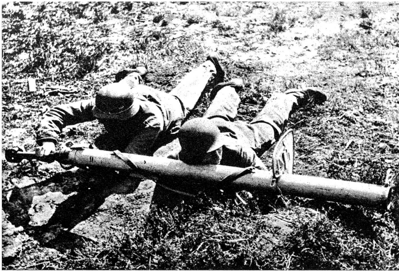
Der „Panzerschreck“, eine neue deutsche Panzerabwehrwaffe. Das Geschoss, das hinten das Abschussrohr ein geschoben wird, zeichnet sich durch grosse Durchschlagskraft auf weite Entfernung und intensive Splitterwirkung aus
