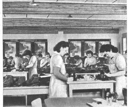
Oben: Einbau der plastischen Innensohle
