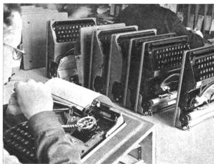
Die Schriftkontrolle bildet einen der hauptsächlichsten Teile des Fertigungsvorganges
