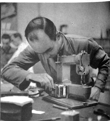
Die Montage und das Einsetzen des kleinen Motors, welcher in die Nähmaschine einkonstruiert ist, stellt eine der letzten Arbeiten in der Montage dar.
