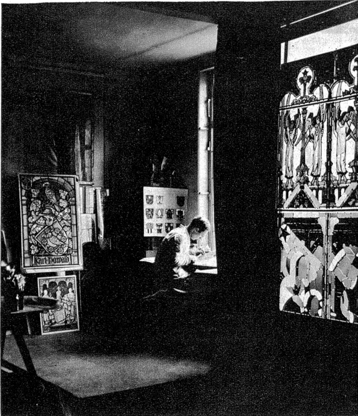
Die Zeichnung wird mit Schwarzlot aufgetragen. Rechts sieht man oben eine bemalte, unten eine unbemalte Scheibe.
