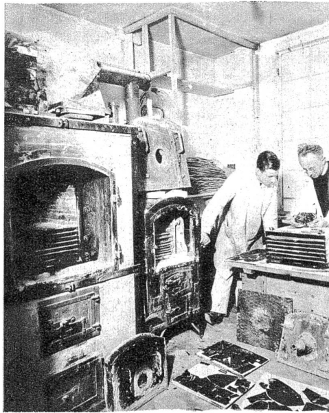
Die Gussplatten werden in den Muffelofen eingelegt. Der Ofen wird zuerst vorgewärmt.
