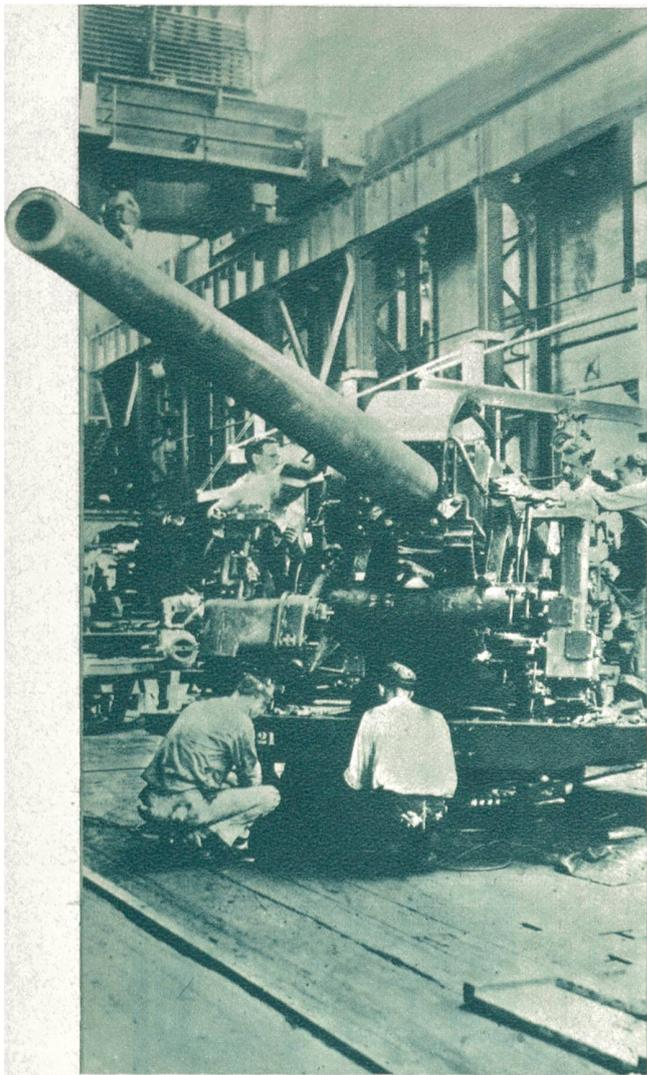
**Montage einer 5 zölligen, neuesten amerik. Schiffskanone:** Im fiebrigen 24-Stunden-Tag (mit Schichten) werden in USA die Schiffskanonen für die kürzlich von der Regierung in Auftrag gegebenen neuen Kreuzer erstellt. Hoffentlich tritt der Ernstfall nicht ein, der diese Kriegsmaschinen in Funktion sehen müsste.
