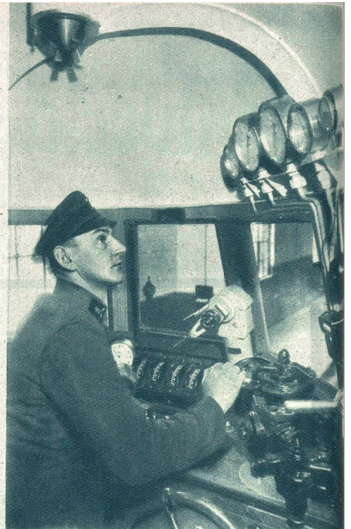
Links: Die mächtigste Dampflokomotive Europas in Paris eingetroffen. Sie faßt 34.000 Liter Wasser und die Kohle gelangt durch eine automatische Förderanlage direkt in den Feuerschlund. Sie wird mit schwersten Zügen im 120-km-Tempo auf der Linie Paris-Cherbourg dahinfliegen, technisch könnte sie jedoch noch eine größere Geschwindigkeit erreichen. — Voran eine Lokomotive aus dem Jahre 1848.
