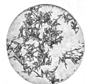
Vielleicht noch schädlicher sind diese spitzen Kristalle, die — wie Nadeln — die feinen Faserwände anstechen und aufräumen. Aufnahme durch das Mikroskop in ebenfalls 200facher Vergrößerung.
