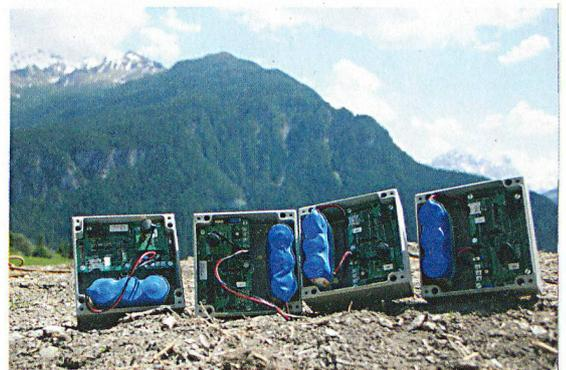
Die RockNet-Sensoren – hier vor der Montage – messen Erschütterungen im Gelände.
