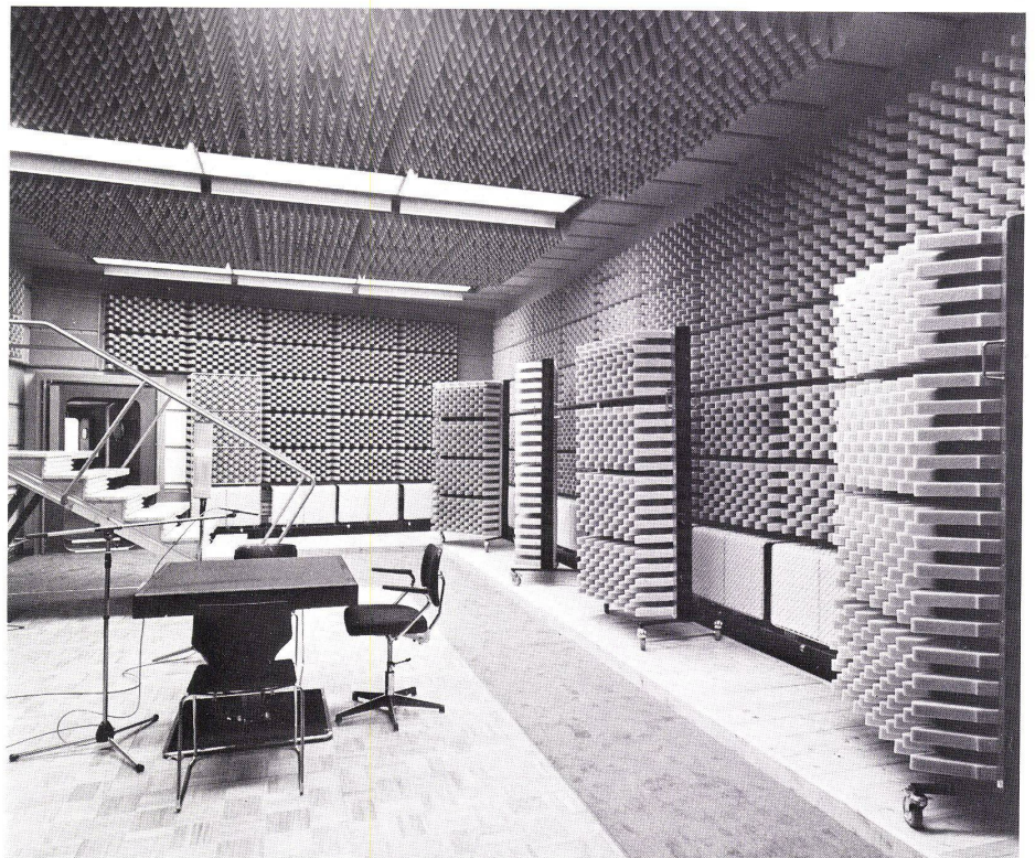
23 Hörsaalstudio mit flexiblen Akustikelementen an den Wänden. Salle d'audition avec parois équipées d'éléments acoustiques flexibles. Audition room with flexible acoustic elements on the walls.
