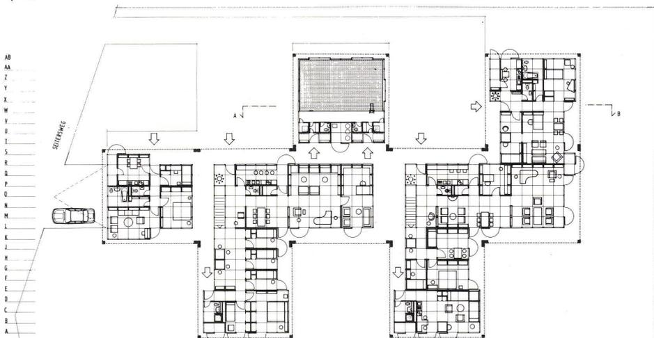
Achsrastrer 120 cm, die einzeln montiert und demontiert werden können. Die Elemente sind durch Quersprossen in fünf Felder geteilt, die wahlweise mit drei verschiedenen Elementen geschlossen werden können.
