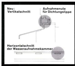
Auch für diese Forderung hat die Firma Piatti schon seit langem gute technische Lösungen gefunden. Neu hat sie folgende Verbesserungen am Wetterschenkel eingeführt: größeres Fassungsvermögen der Wasserkammer, bessere Entleerung durch Schlitze (statt durch runde Löcher), Aufnahmenute für Dichtungslippe
