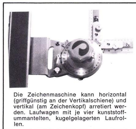
Die Zeichenmaschine kann horizontal (griffgünstig an der Vertikalschiene) und vertikal (am Zeichenkopf) arretiert werden. Laufwagen mit je vier kunststoffummantelten, kugelgelagerten Laufrollen.
