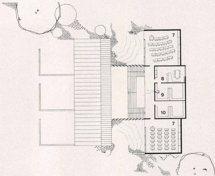
Grundriß Eingangs- und Mittelgeschoß / Plan de l'étage central où donne l'entrée / Plan of ground and middle floor
