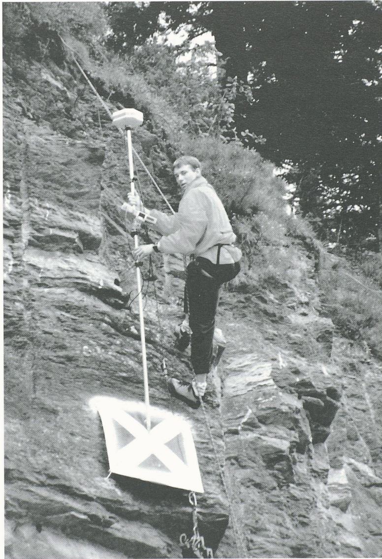
Fig. 2. - Mesures de points topographiques pour une étude des avalanches dans la vallée de la Sionne (VS). Sont visibles le récepteur GPS et une balise pour la photographie (Photo EPFL)
