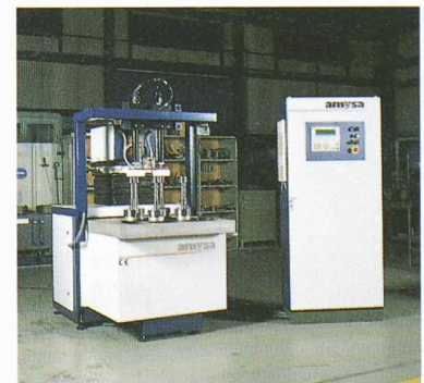
Fig. 4. – Machine modulaire pour le chauffage par induction. On distingue à gauche le corps de la machine et les inducteurs, à droite le générateur et la commande.
