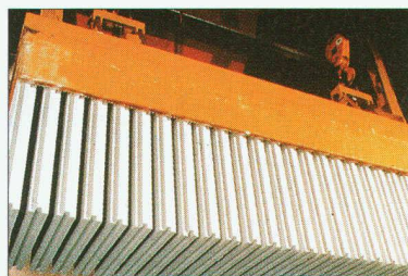
Carreaux de plâtre en cours de fabrication.
