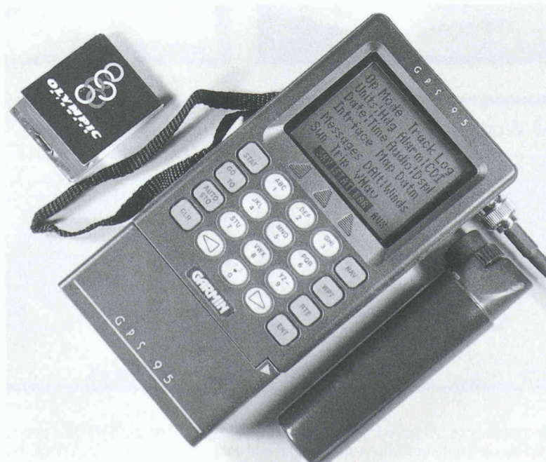
Fig. 5. – Un récepteur GPS portable destiné à l'aviation: le Garmin AV 95; la pochette d'allumettes permet de juger de ses dimensions modestes. L'antenne, cylindre noir posé le long de l'instrument, est soit directement fixée sur celui-ci, soit montée sur un emplacement favorable à la réception (p. ex. sur le haut du pare-brise de l'avion).
