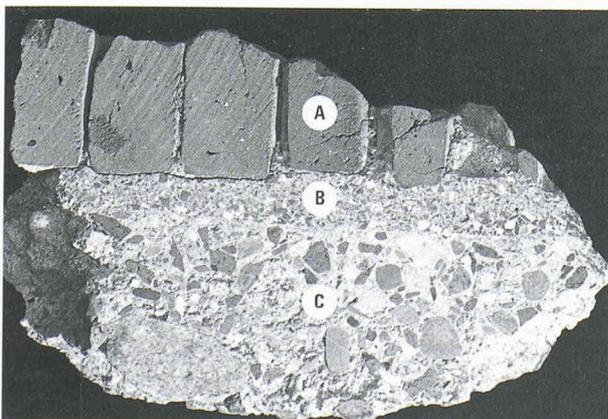
Fig. 3. — Lousonna-Vidy: dallage en briques de terre cuite (A) d'époque romaine (env. II<sup>e</sup> siècle apr. J.-C.) sur une chape (B) et un béton (C), d'excellente qualité, contenant du tuileau
