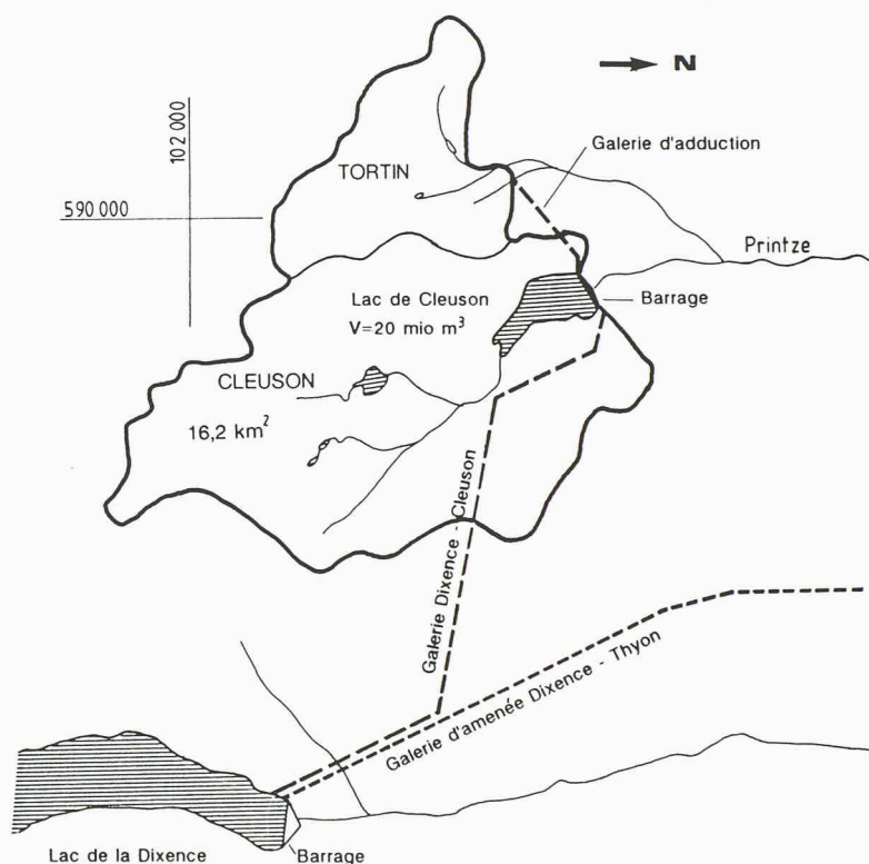
Fig. 1. – Barrage de Cleuson: situation d'ensemble de l'aménagement
