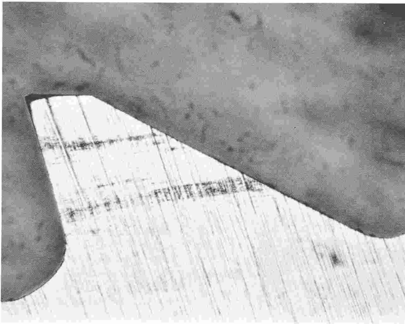
Fig. 5.— Dent de la scie circulaire pour composites à matrice thermodurcissable. Grossissement: 50X.
