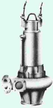
Débit max. 9000 m<sup>3</sup>/h. Hauteur de refoulement max. 50 m. Matériaux: Fte grise, inox 1.4021. Exécution avec moteur pour montage immergé ou à sec, IP 68 ou Ex. Etanchéité de l'arbre d'entraînement par garniture mécanique en métal dur ou en carbone de silicium.
