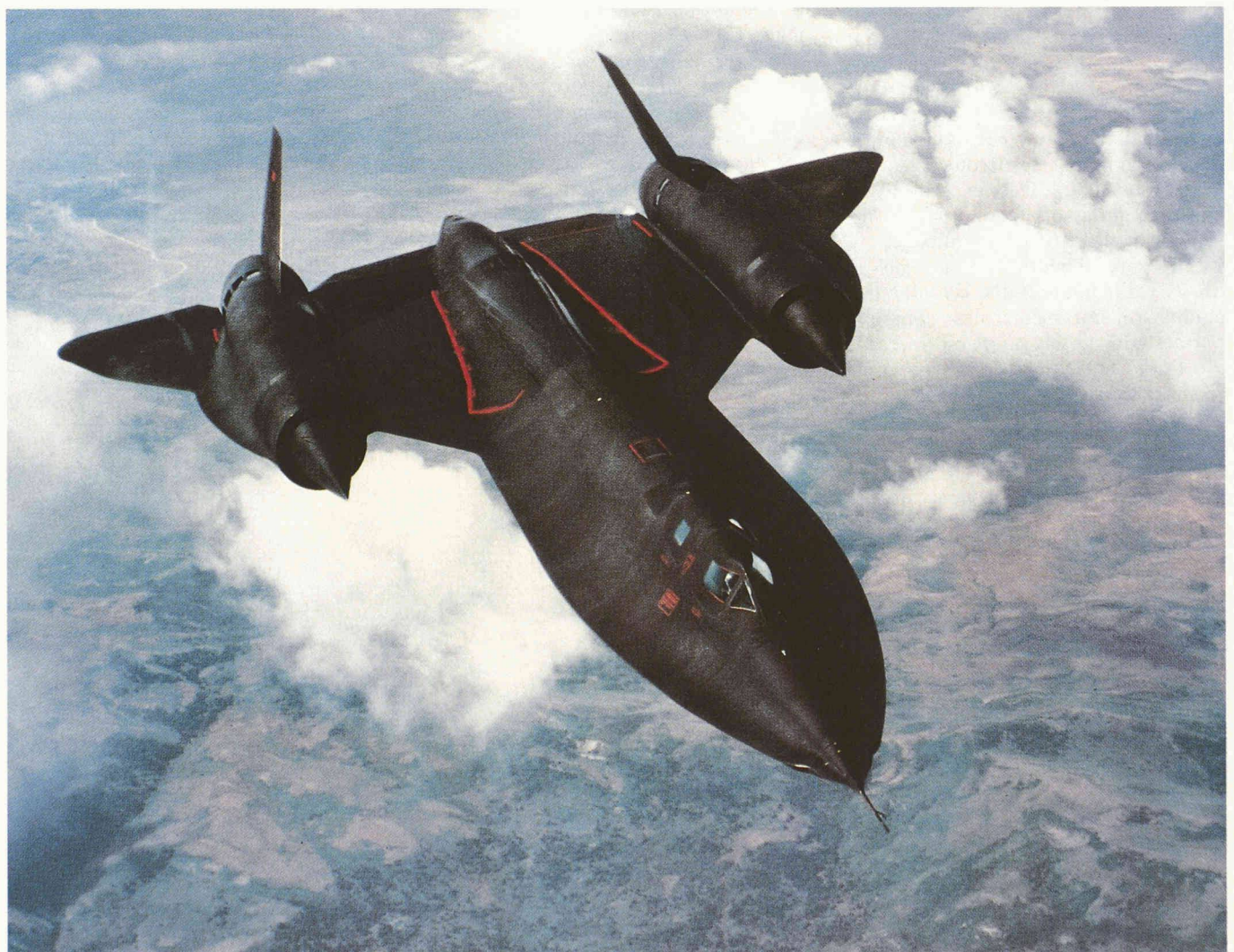
Un SR-71 en vol subsonique. On distingue sur les ailes, entre le fuselage et les réacteurs ainsi que derrière l'aile droite, les trainées de carburant s'échappant des réservoirs structuraux, qui ne deviendront étanches que grâce à la dilatation thermique de la structure à grande vitesse.
