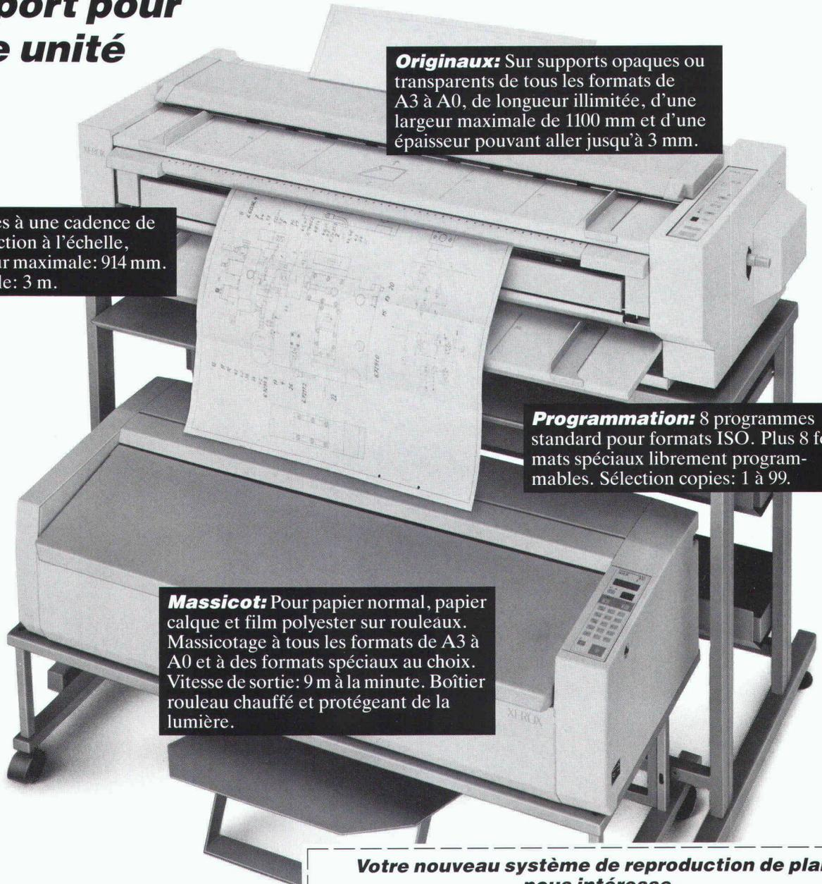
**Originaux:** Sur supports opaques ou transparents de tous les formats de A3 à A0, de longueur illimitée, d'une largeur maximale de 1100 mm et d'une épaisseur pouvant aller jusqu'à 3 mm.
