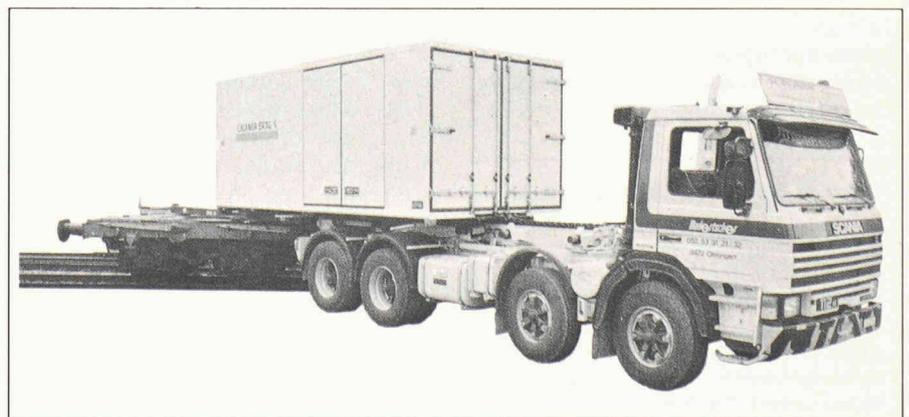
Moyennant l'équipement des wagons et des camions, le système ACTS permet de s'affranchir d'installations fixes pour les échanges intermodaux.
