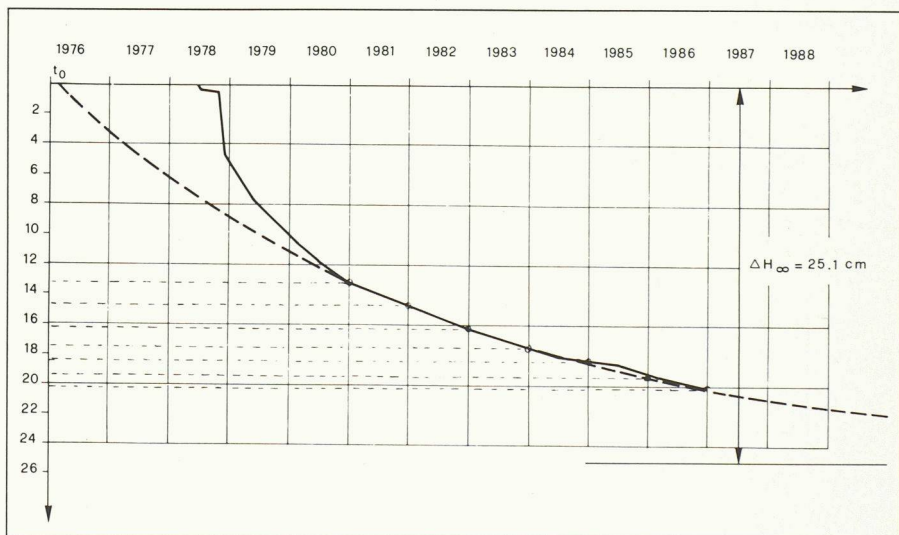
Fig. 4. - Courbe \Delta H = f(t) d'une culée de pont avec son remblai d'accès. — Mesures — — — Calculs
