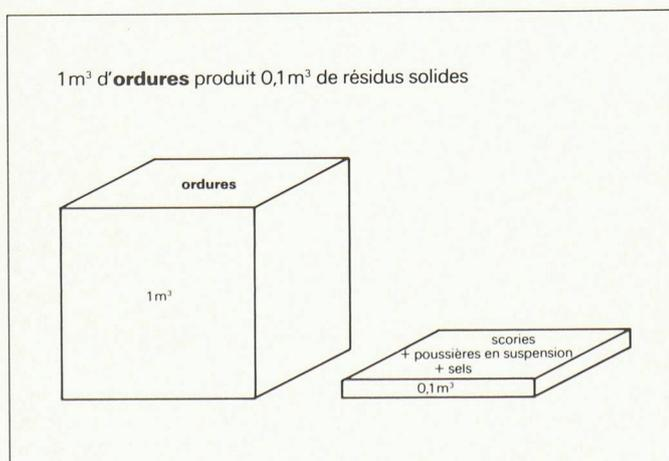
Fig. 2. - Réduction du volume des ordures par incinération.
