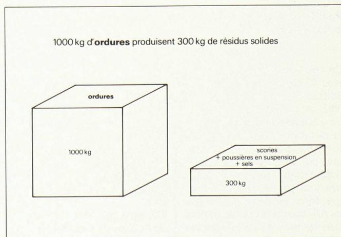
Fig. 3. - Réduction du poids des ordures par incinération.
