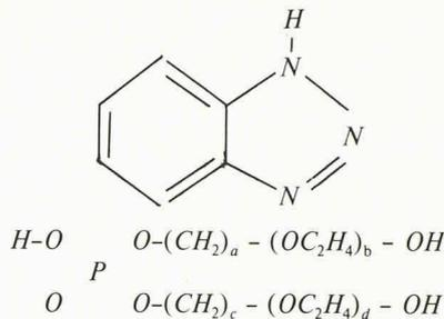
Le mode d'action de ces solutés est le suivant. Le benzotriazole forme un complexe insoluble extrêmement adhérent à la surface des seuls métaux *Cu* et *Ag* (dont le mode de formation est mal connu). Quant au phosphate organique, sa molécule très plate et asymétrique forme des liaisons Van der Wals en s'ab-
