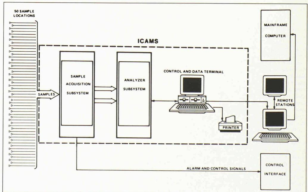
Schéma du système de détection chimique ICAMS.
