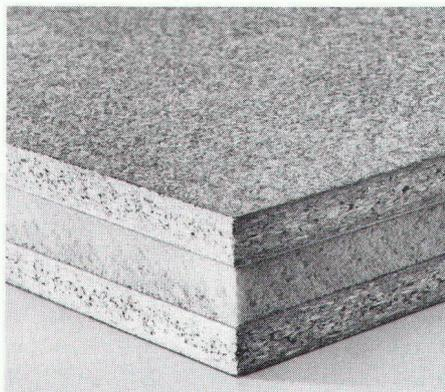
Les éléments HOMISOL DUO sont constitués de deux panneaux de particules collés sans formaldéhyde et d'une mousse intermédiaire de polyuréthane résistant à la compression. Ils sont résistants au trempage d'imprégnation et peuvent être surfacés, plaqués ou peints à volonté. La structure sans entretoise garantit un coefficient k uniforme de transmission de chaleur. Demandez nos planches détaillées sur les éléments et leur technique de fixation. Appelez-nous.
