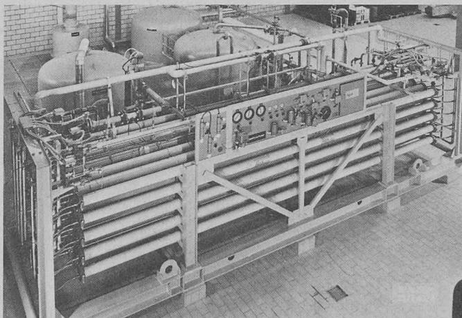
Installation d'osmose inverse de la Swissair (aéroport de Zurich-Kloten), d'une capacité de 730 m<sup>3</sup>/jour.
