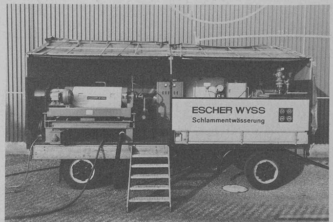
Fig. 2. — Installation pilote mobile pour l'étude des boues d'eaux usées en service en Espagne.
