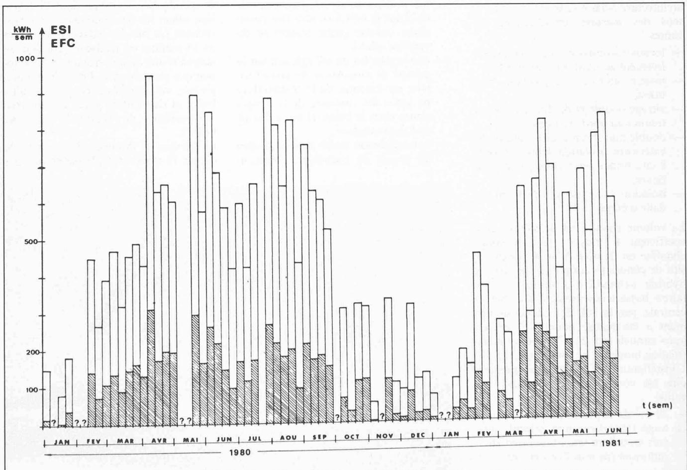
Fig. 3. — Evolution des valeurs et du rapport de l'énergie fournie par les capteurs (EFC) à leur sortie, sur l'énergie solaire incidente dans leur plan (ESI) par semaine.
