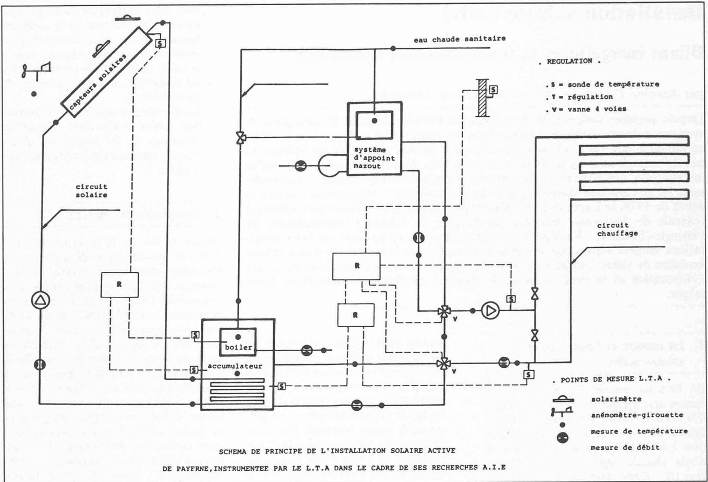
Fig. 2 — Schéma de principe de l'installation.
