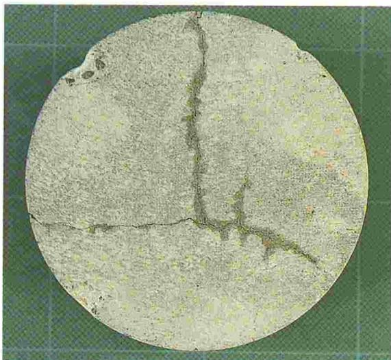
Fig. 7. - Carottage au droit de fissures.
