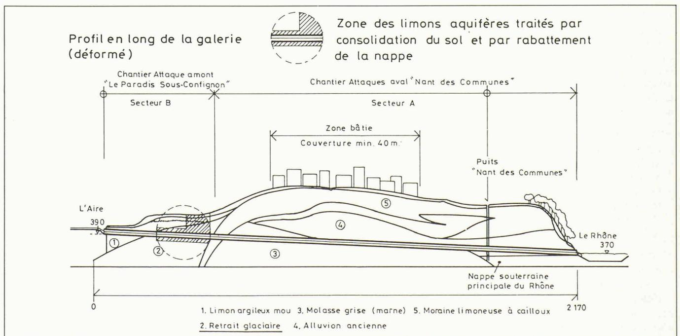
Fig. 2. — Profil en long avec sens des attaques.
