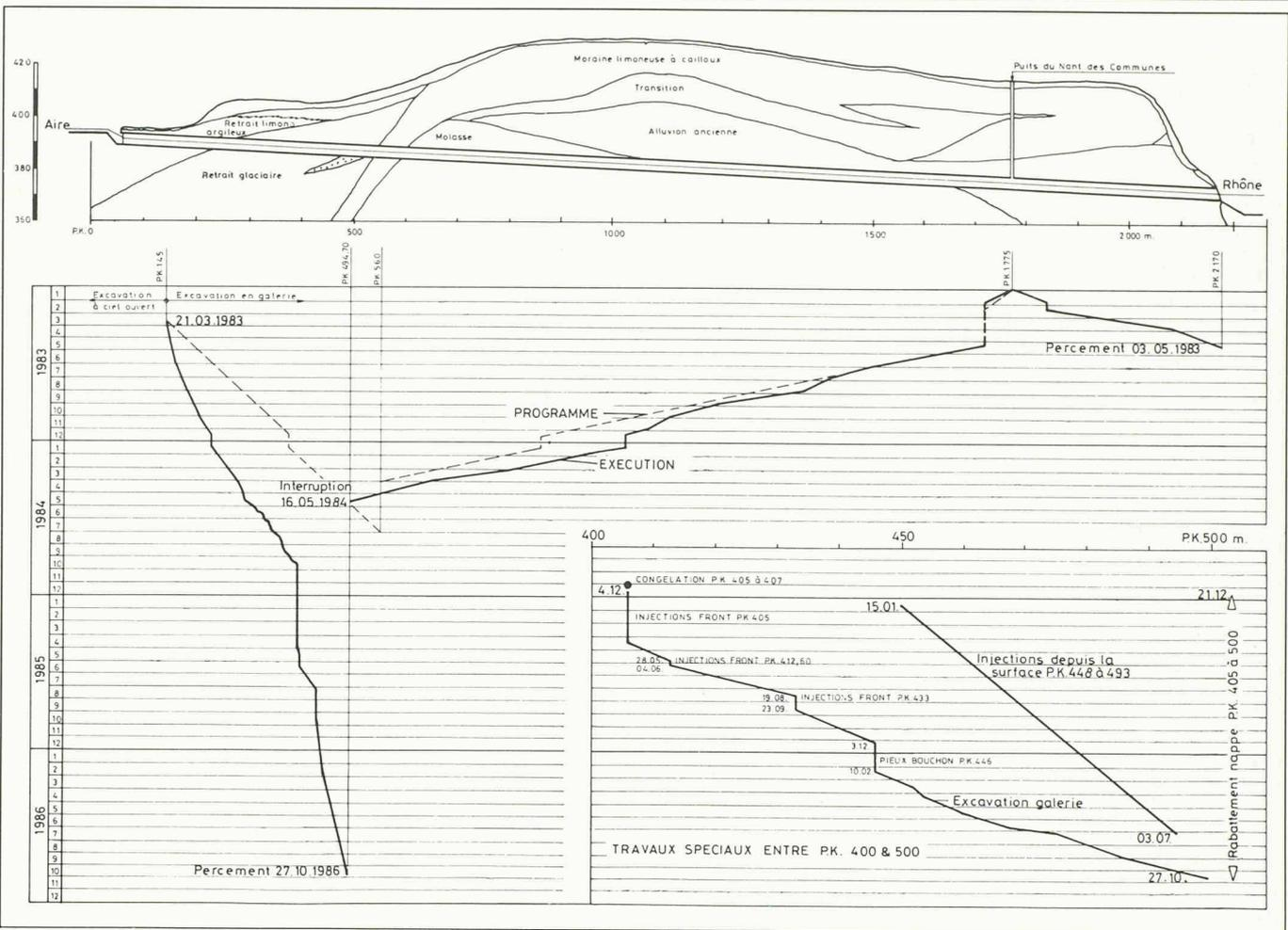
Fig. 3. — Avancement des travaux d'excavation et des travaux spéciaux entre PK 400 et 500 (encadré de droite).
