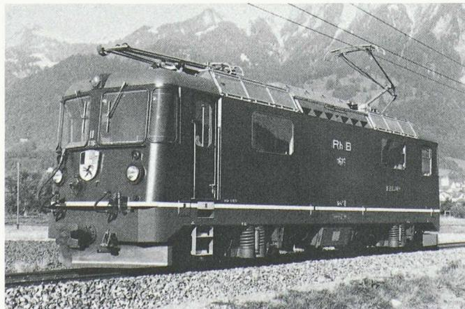
Locomotive à thyristors Bo'Bo' Ge 4/4<sup>III</sup> des Chemins de fer rhétiques. (Photo SLM)
