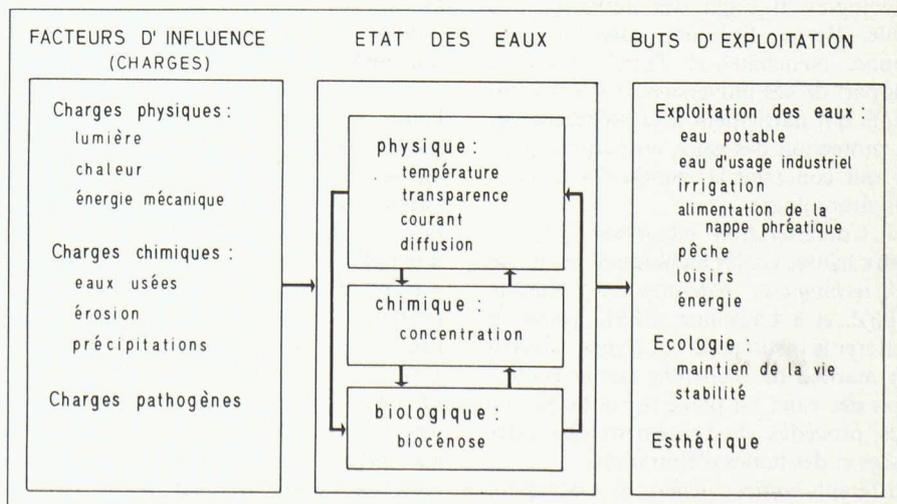
Fig. 1. — Relations entre les charges des eaux, l'état des eaux et les buts d'exploitation.
