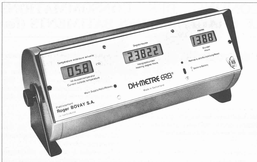
Fig. 3. — Thermomètre-intégrateur: DH-METRE ERB.
