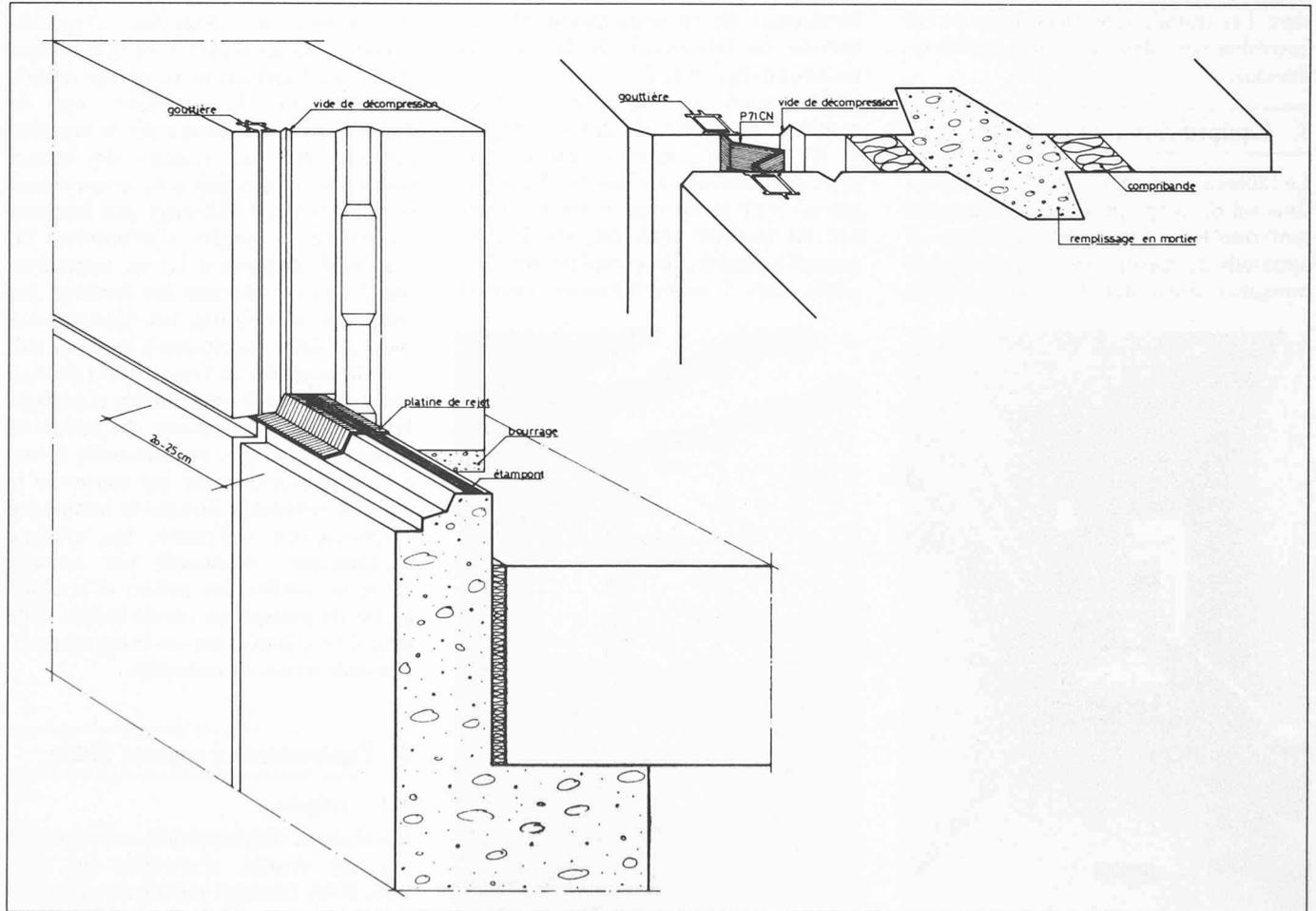
Fig. 17. — Jointoyage des éléments préfabriqués de façades.
