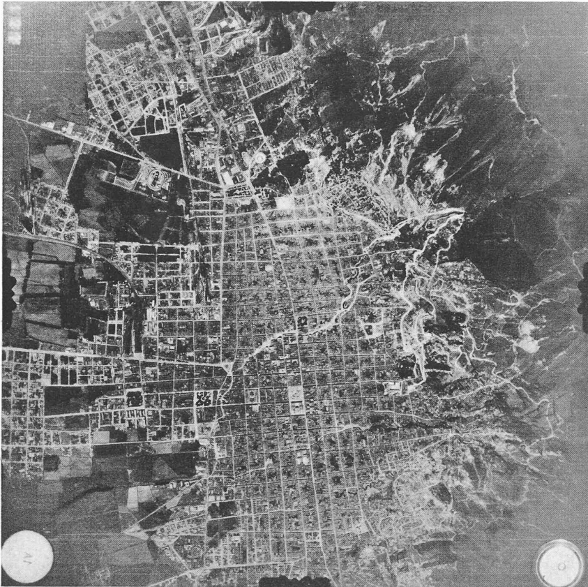
Fig. 5. — Bande de vol de l'aérotriangulation. Vue partielle de Bogota. Echelle approximative du cliché original 1 : 22 000. Les régions qui ne sont pas comprises dans les bandes de vol sont photographiées dans les mêmes conditions à l'aide de vols en damier. Ces vues aériennes sont utilisées pour l'identification des périmètres des unités organiques cadastrales, comme croquis d'investigation préliminaire du cadastre préparatoire, et servent de base à la confection des cartes préliminaires : cartes municipale, militaire et agricole.
