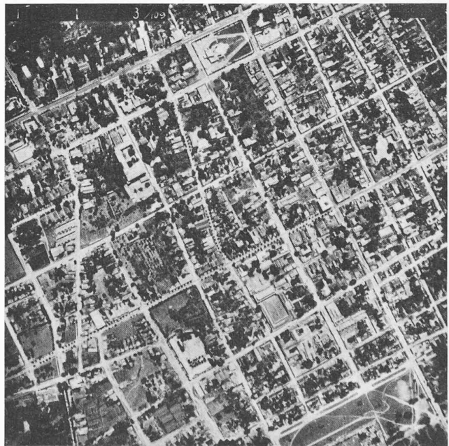
Fig. 6. — Vue d'un vol complémentaire du cadastre technique ; l'échelle est dictée par la densité des détails à identifier, partant la hauteur du vol. Vue d'un secteur de la ville de Barranquilla. Ces vues sont utilisées pour l'identification des périmètres des unités territoriales juridiques et économiques. Echelle approximative du cliché original 1 : 12 000.
