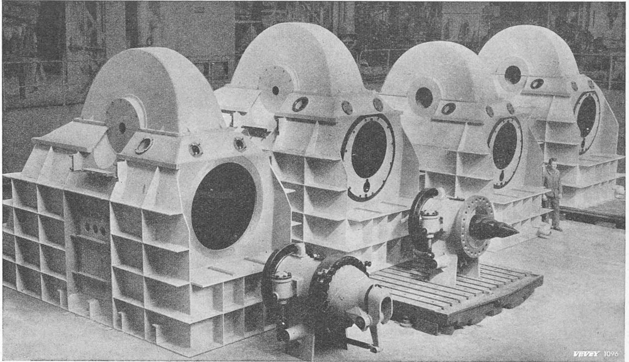
Fig. 4. — Bâti des turbines Pelton de la centrale de Saint-Martin-Vésubie (Electricité de France).
