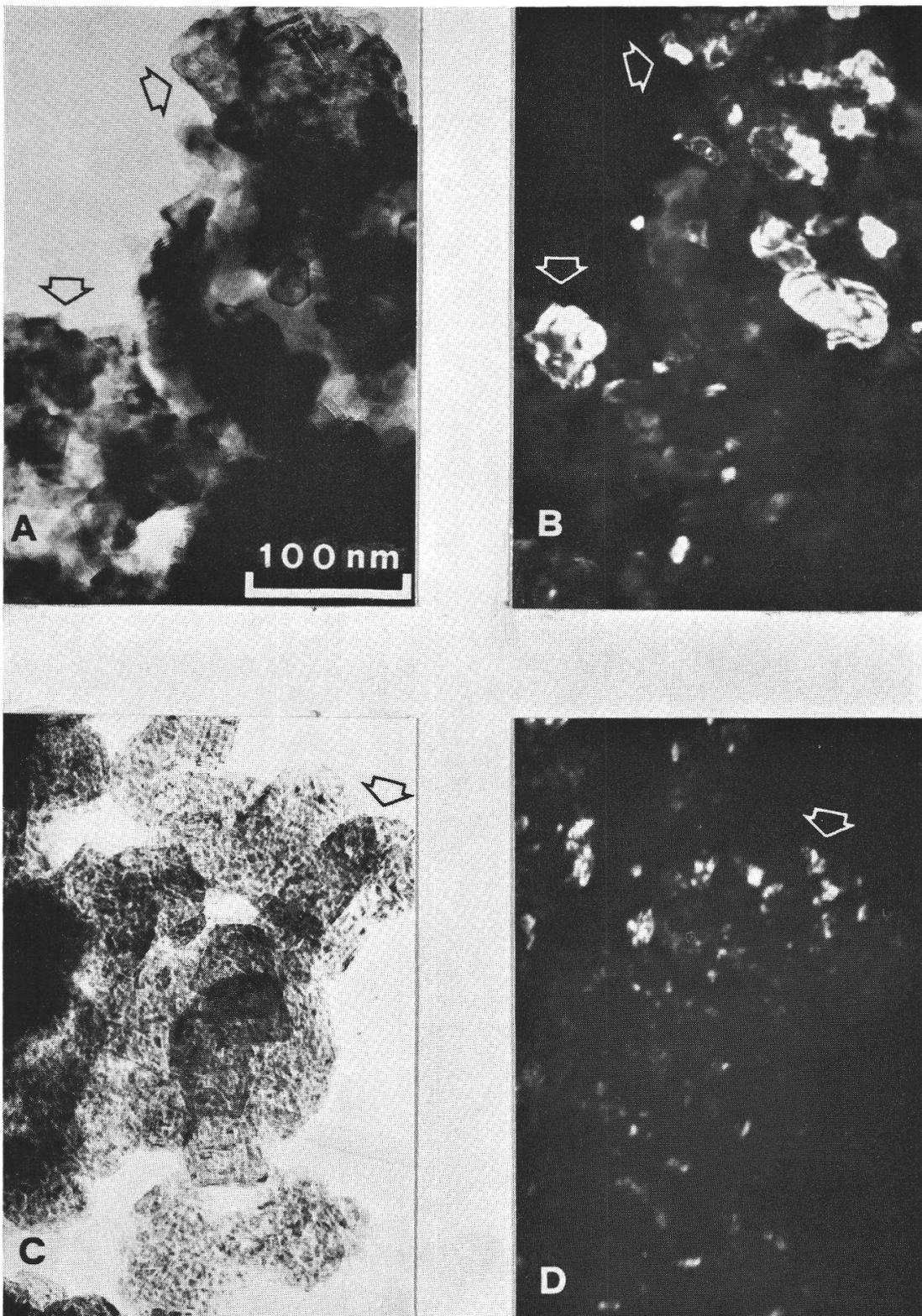
Micrographies des calcites artificielles avec un agrandissement final de  $200.000 \times$  (Philips EM — 300). « STURGES 80 » en mode image (A) et en champ noir (B), et « CALOFORT-U » dans les mêmes conditions (C et D). Les taches blanches dans B et D correspondent à des microcristallites favorablement orientés. Les flèches indiquent les mêmes régions en champ clair et en champ noir.
