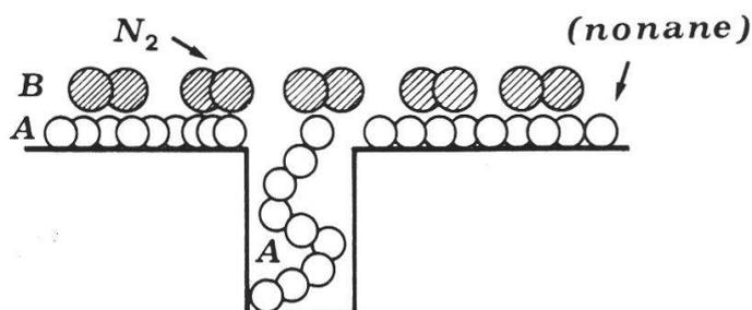
Fig. 5. Principe de la méthode de Gregg et Langford pour la détection des micropores. Dans une première étape (A), du nonane est adsorbé à température ambiante. L'azote est ensuite adsorbé à  $-195^\circ C$ , et ne recouvre que la surface externe du solide (B).
