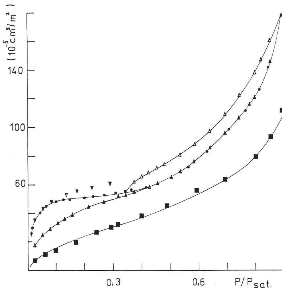
Fig. 4. Isothermes d'adsorption du néopentane sur les carbonates artificiels et naturels, à  $-10^{\circ}\text{C}$ . Les isothermes sont réduites à l'unité de surface ( $1\text{ m}^2$ ).
