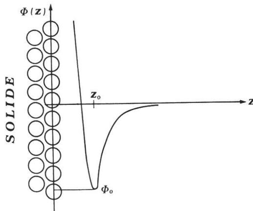
Fig. 1. Variation de l'énergie potentielle d'interaction gaz-solide  $\Phi(z)$ , en fonction de l'éloignement de la surface.
