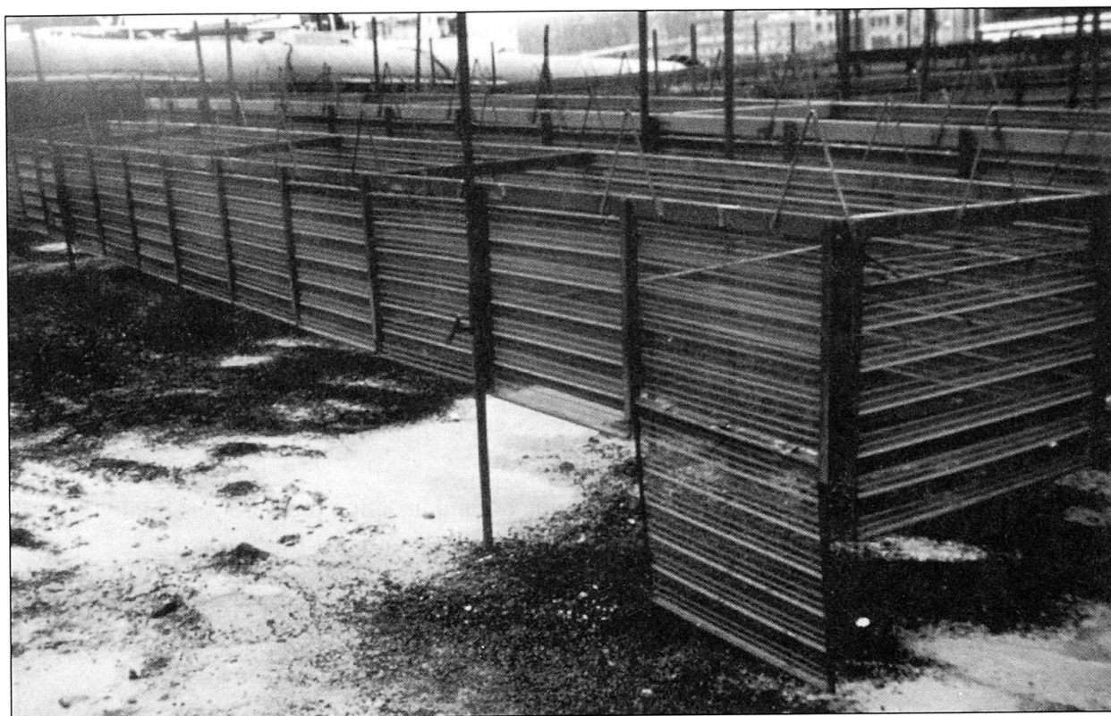
Fig. 4 Metal mould for keelblocks
