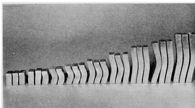
Fig. 2. Eprouvettes courtes après essais de flambement.
