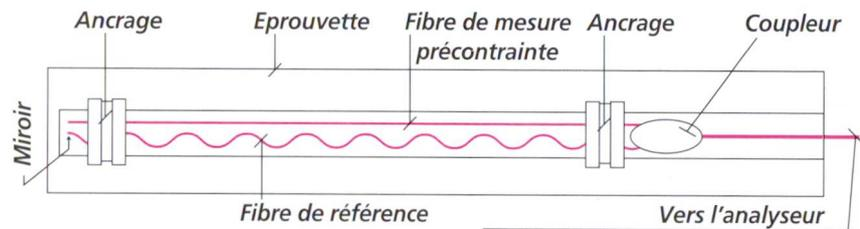
Fig. 1 Structure d'un capteur Sofo (voir texte) selon [1].
