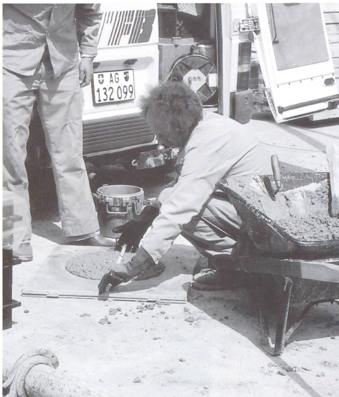
Le contrôle du béton frais est un élément important pour l'assurance de la qualité du béton contenant des adjuvants.
