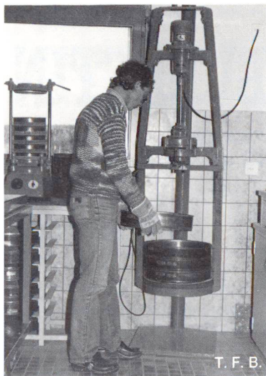
Séries de petits et de grands tamis sur l'appareil de vibration
