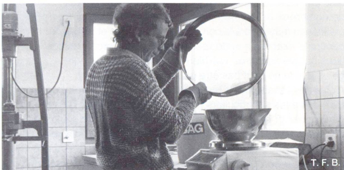
Pesage d'une fraction granulométrique
