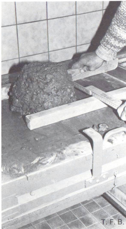
Mesure de l'étalement: mesure de la masse étalée
