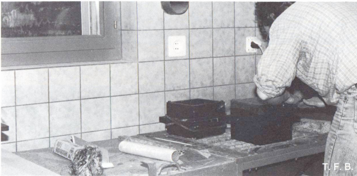
Finissage d'un cube d'essai dans un moule en plastique
