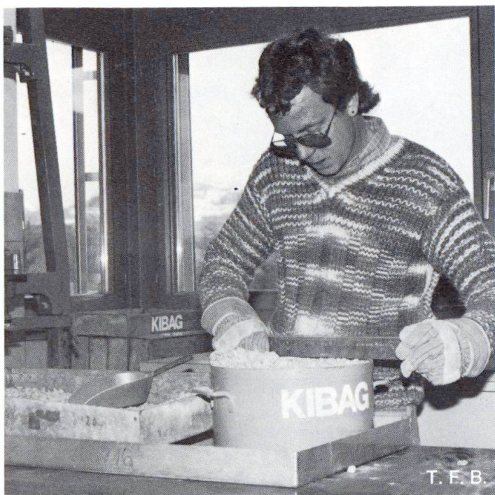
Détermination de la densité apparente du granulat
