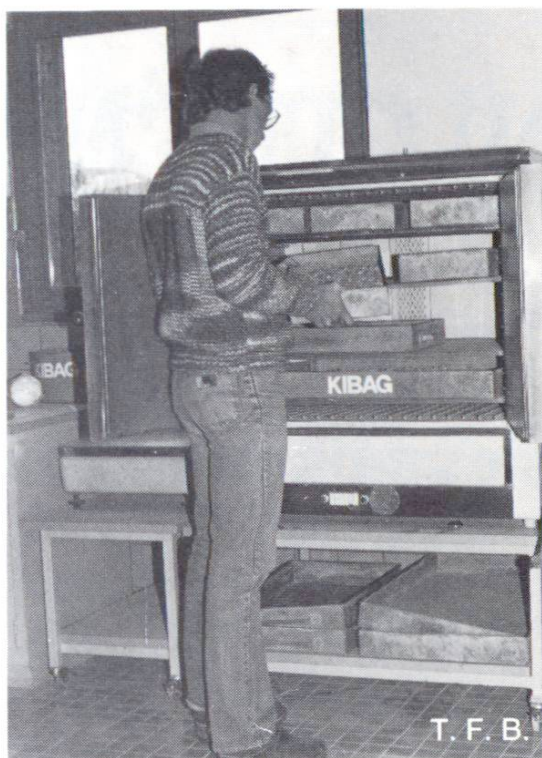
Séchage du granulat avant tamisage
