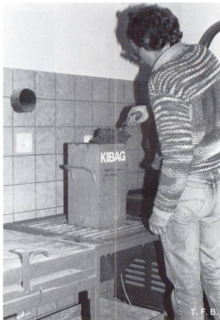
Degré de serrage: remplissage du récipient
