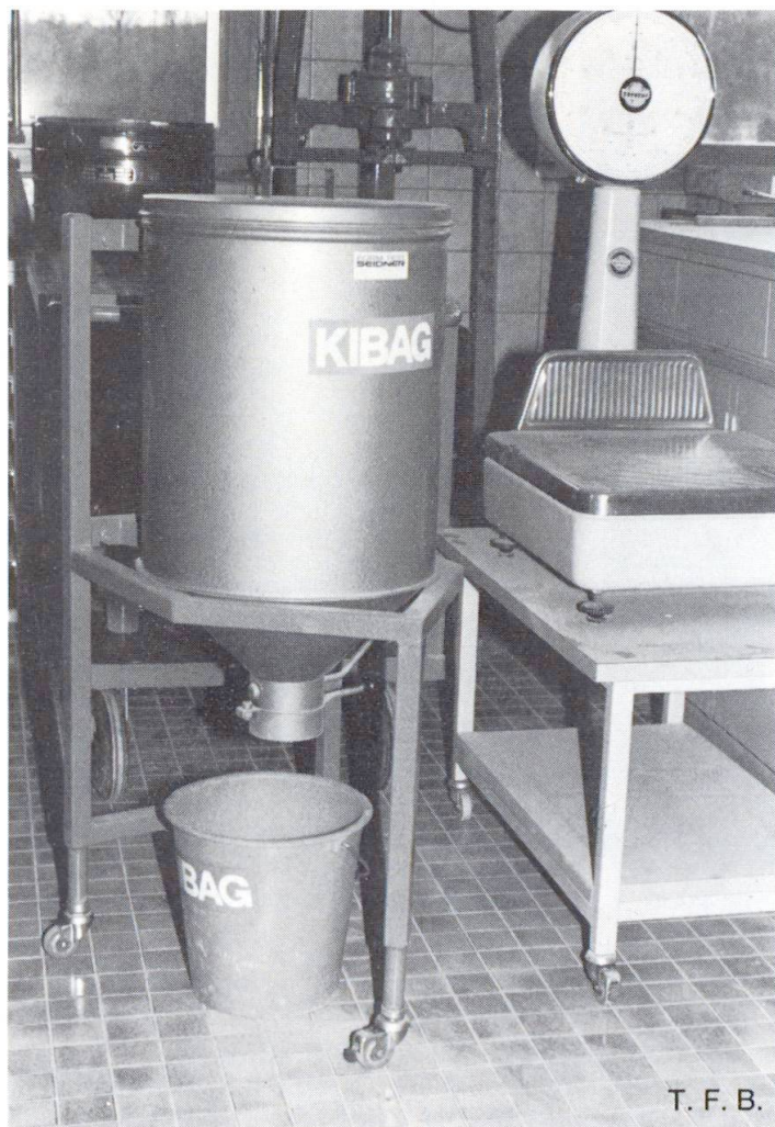
Silo de granulat pour laboratoire ainsi que balance
