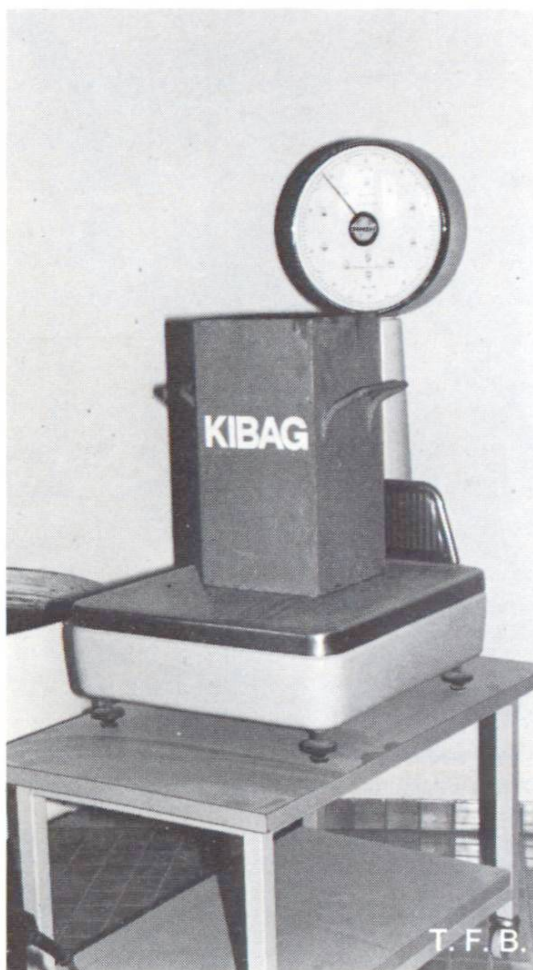
Détermination de la densité du béton frais
