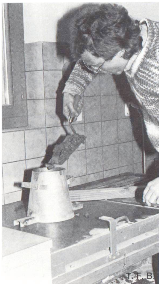
Mesure de l'étalement: remplissage du cône
