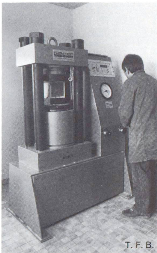
Essai de résistance à la compression sur cube
