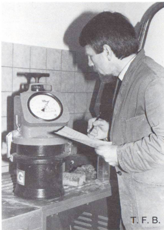
Détermination de la teneur en air d'un béton à air occlus
