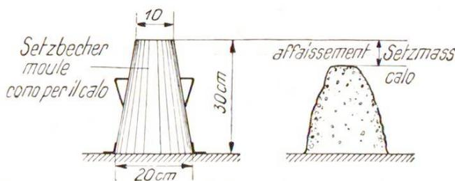
Fig. 2. Essai d'affaissement
