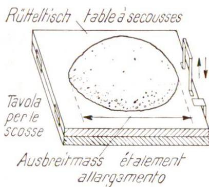
L'essai d'étalement a lieu sur la table à secousses. De même que pour l'essai d'affaissement on remplit de béton le moule tronconique avec la différence, qu'une fois le moule enlevé, on secoue la masse de béton de façon à ce qu'elle s'étale. Le diamètre du gâteau ainsi formé s'appelle l'étalement (fig. 3).
