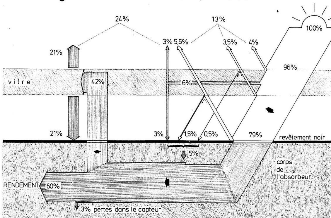
Le total des pertes, pour une température de fonctionnement de 40°C, est de 40%, soit 24% de rayonnement infra-rouge, 13% de rayonnement visible réfléchi et diffus, 3% de pertes thermiques dans le capteur.
